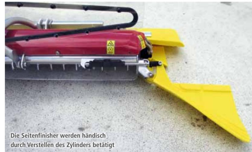
Die Seitenfinisher werden händisch durch Verstellen des Zylinders betätigt
