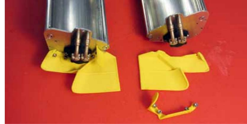
Hilfsfinisher, Hydraulikmotor und Seitenfinisher-Halterung im montierten Zustand
