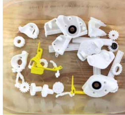
Die 3D-Druckteile sind verwechslungssicher nummeriert
