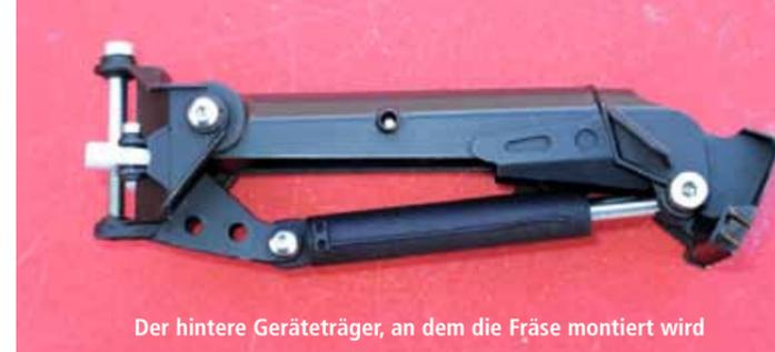
Der hintere Geräteträger, an dem die Fräse montiert wird
