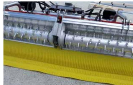
Die Fräsrollen und deren gekapselte Getriebe im Detail
