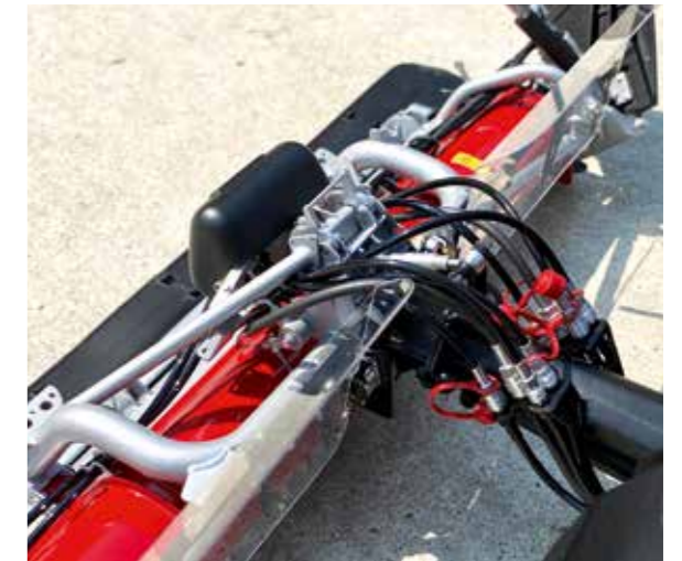
Schlauchkupplungen am Geräteträger
