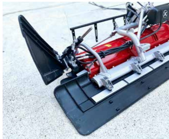
Einzigartiger Hydraulizylinder für die Seitenfinisher
