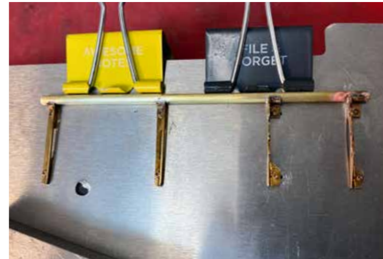
Lötschablone für den Überwurfschutz mit CNC-gebohrten Befestigungslöchern
