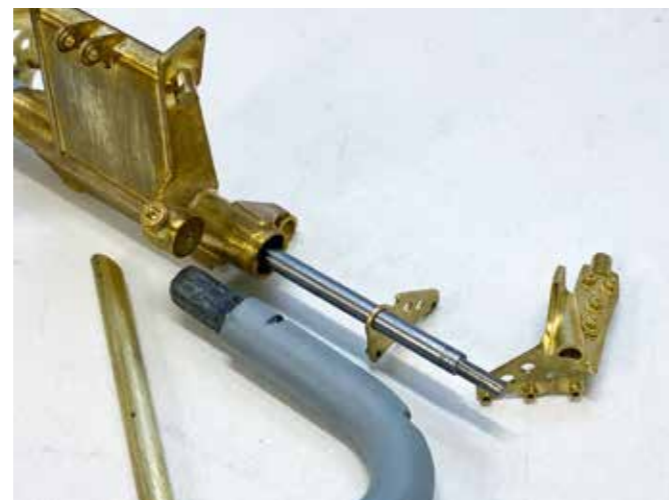
Stabile Verbindung der Teile mit einer 3-mm-Stahlrundstange
