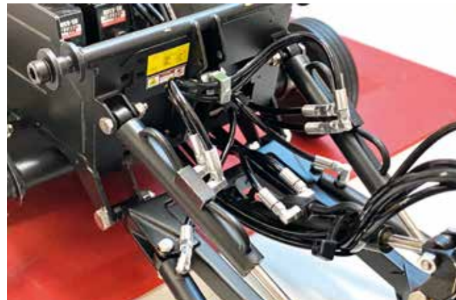
Schlauchführung und Anschlussnippel entsprechen weitestgehend dem Original
