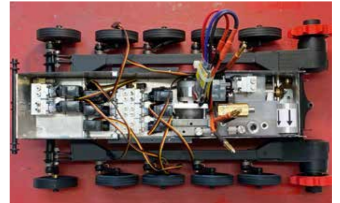
Hydraulikkomponenten in der Fahrwerkswanne
