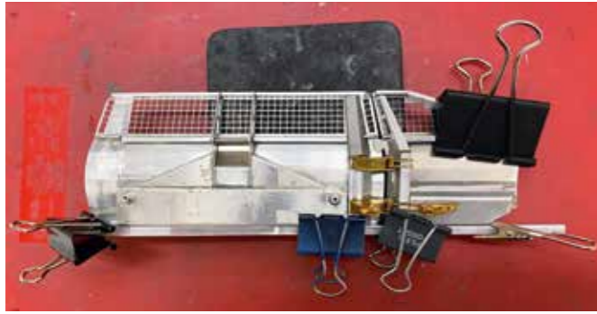
Beim Verkleben ist genaues Ausrichten der Teile absolut wichtig
