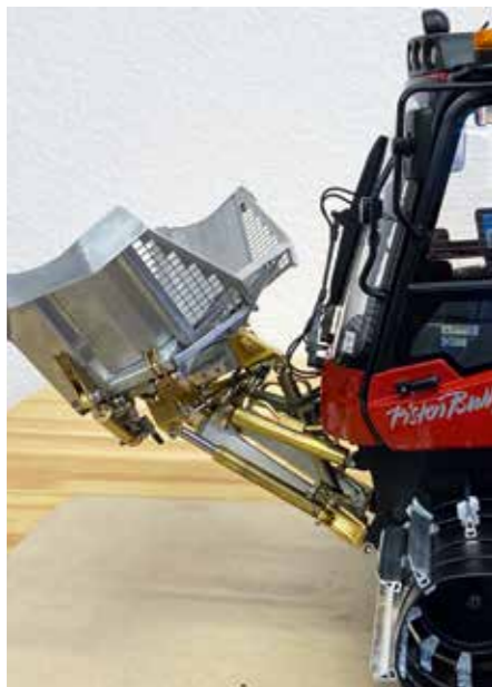
Beim Trockentest sieht man den gewaltigen Verstellbereich des Park-Schildes
