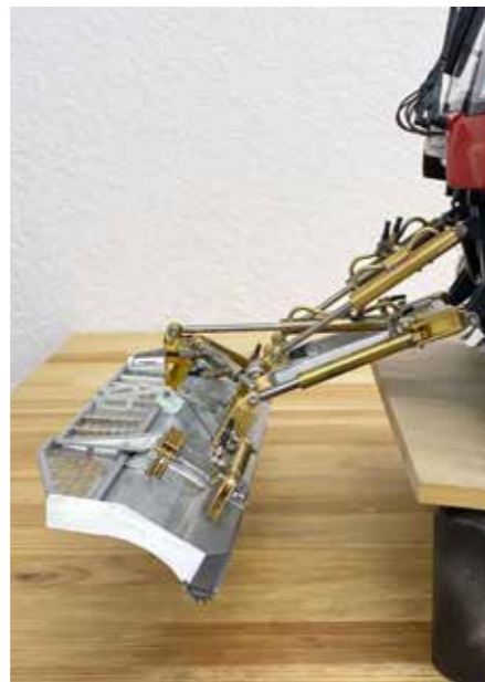
Beim Trockentest sieht man den gewaltigen Verstellbereich des Park-Schildes
