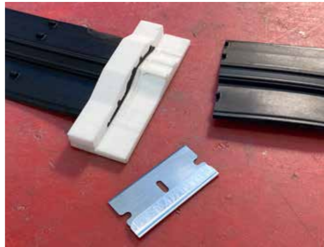
Schneidevorrichtung für exaktes Trennen und Verkleben des Finishers
