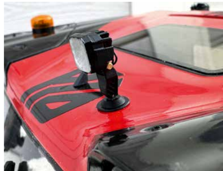
Ein winziges Linear-Servo dreht den Suchscheinwerfer auf dem Dach
