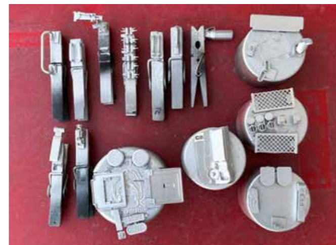
Zum Schutz vor UV-Strahlung werden alle Kleinteile silber grundiert
