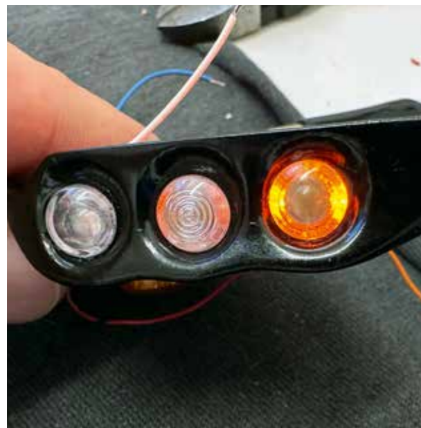
Der Ringeffekt des Blinkers wird mit zwei seitlichen orangenen LEDs erzeugt
