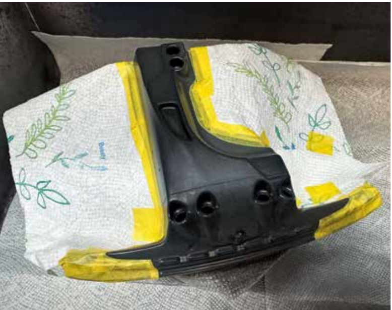
Lackieren der Mittel-tunnelabdeckung
