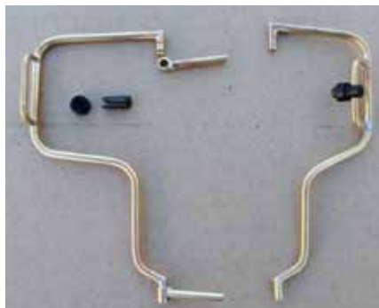
Fertig verlötete Spiegelhalterungen mit Befestigungsteilen
