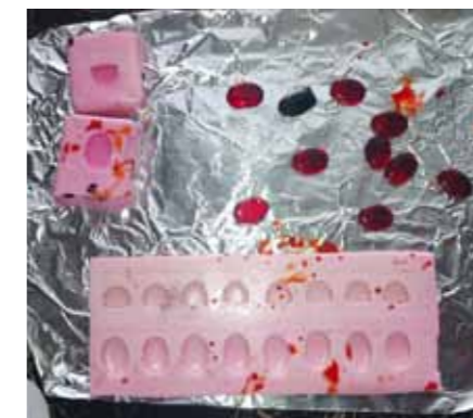
Produktionsformen für die zweifarbigen Leuchtengläser
