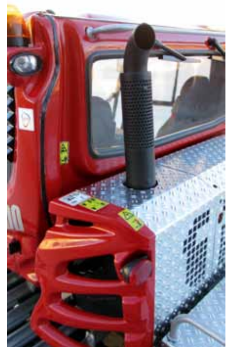
Auspuff aus 3D-Sinterdruck
