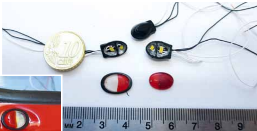
Kombileuchten mit eingelöteten Micro-LED
