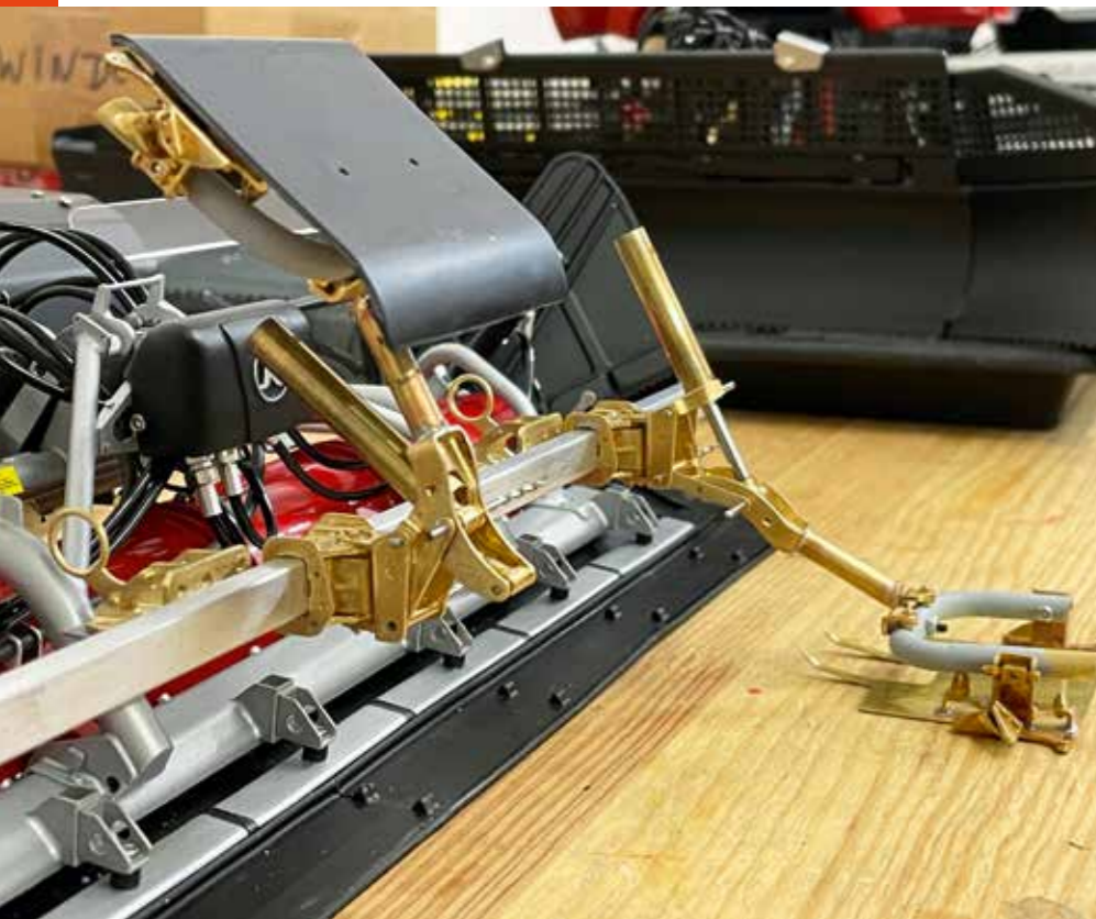
Der Hebemechanismus ist ein technischer Leckerbissen mit einem virtuellen Drehpunkt
