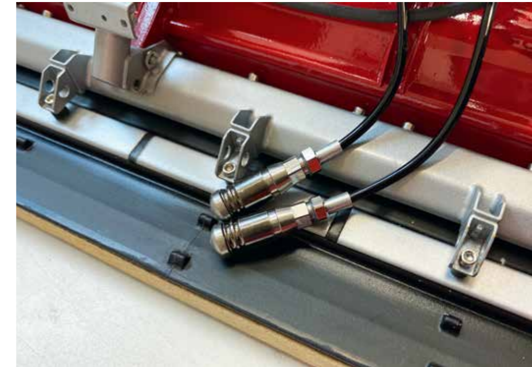
Am Pistenbully sind funktionsfähige Miniatur-Schnellkupplungen von ScaleART verbaut
