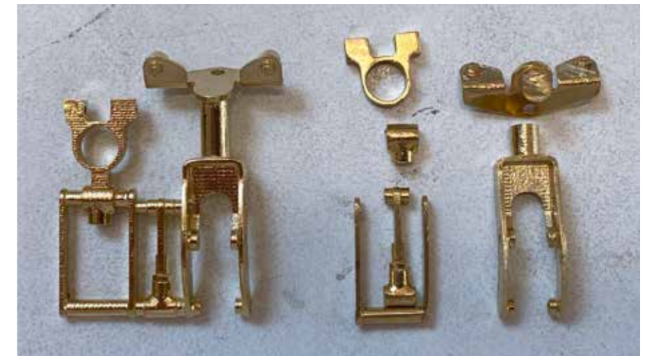
Die filigranen Messingteile wurden als Gruppe gedruckt und anschließend getrennt
