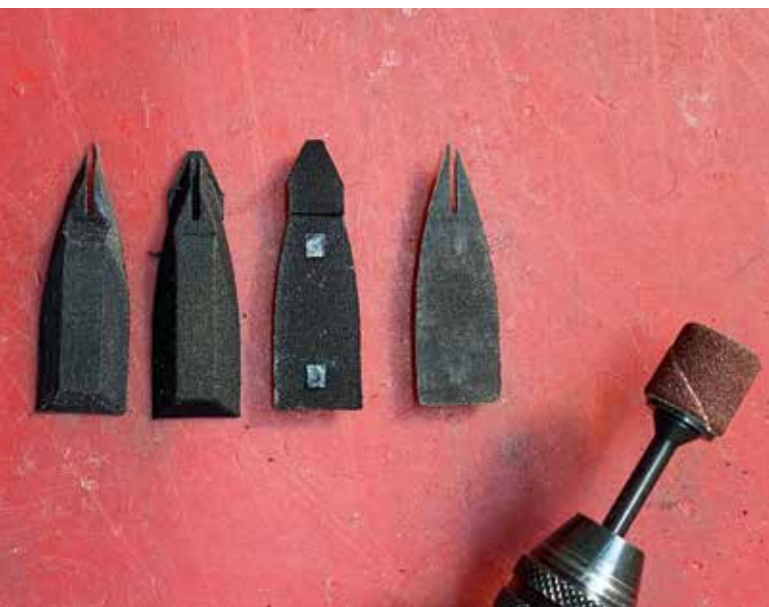
Bei den Loipenspurkeilen aus Nylon-Druckteilen kam ein Proxxon-Handtool zum Einsatz
