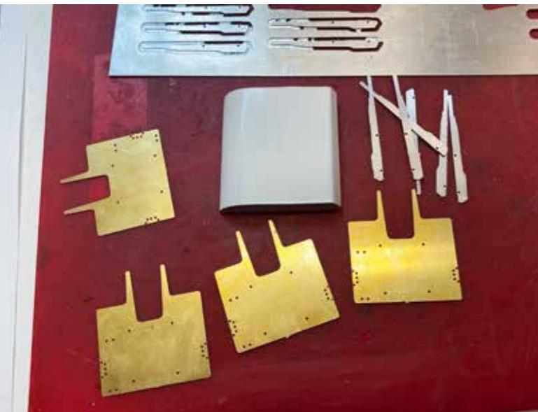
CNC-gefräste Messingplatten mit Bohrungen für die Spurplatten
